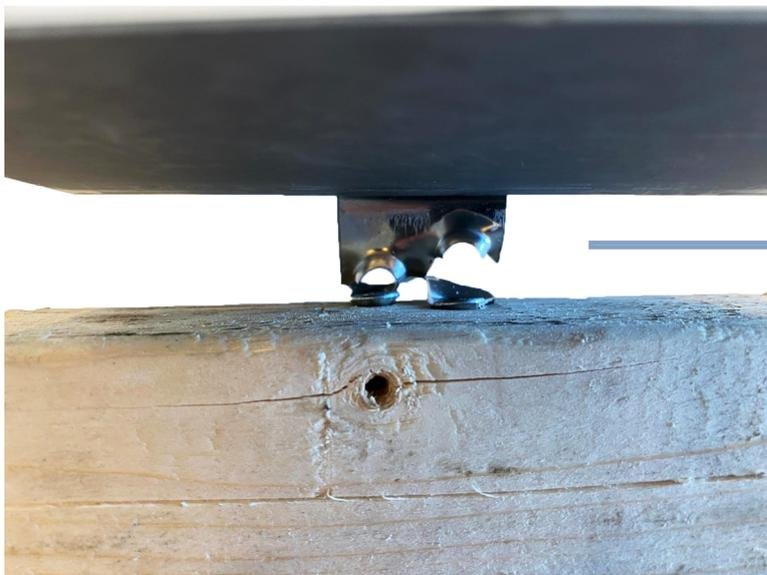
Suite aux tests effectués sur les pattes de fixation, il en ressort que le point de rupture potentiel à prendre en compte est toujours l'endroit où la vis est tirée à travers la perforation. Le résultat le plus optimal est obtenu en ajustant la tête de la vis.
