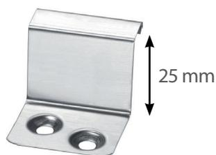
Lorsqu'on combine une patte traditionnelle d'une hauteur de 25 mm avec une natte structurée de 8 mm d'épaisseur, la natte de ventilation s'écrase, la couverture métallique se bombe, la ventilation est bloquée, et la condensation se concentre aux points des fixations ce qui risque d'entraîner une corrosion de la feuille métallique en sous-face.
